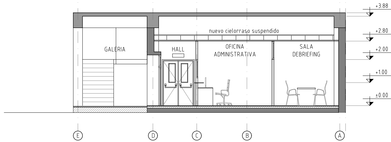
CORTE D-D' CENTRO DE SIMULACION FHCSyS Escala 1:100
